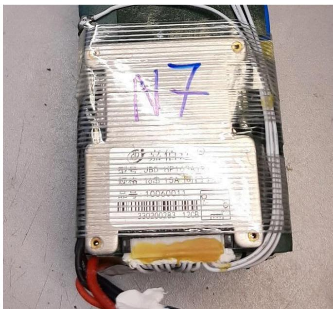
Рисунок 2.1.5 – Конструкция блока аккумуляторов АКБ «№7»
