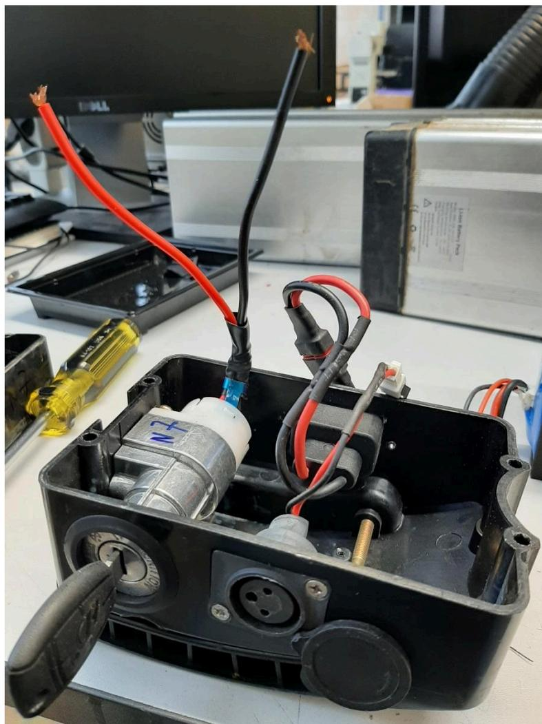
Рисунок 2.1.2 – Обрыв проводов под передней пластиковой крышкой
